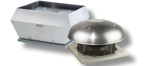
Вентиляторы DVS/DHS оснащены рабочим колесом с лопatkами, загнутыми назад и двигателем с выносным ротором. Корпус выполнен из стойкого к воздействию морской воды алюминия. Рама изготовлена из оцинкованной стали с защитным порошковым покрытием. Вентиляторы DVSI имеют слой звукоизоляции толщиной 50 мм.
