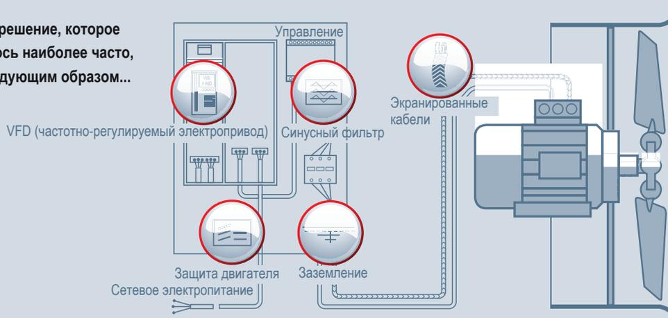
Обычные вентиляторы с частотно-регулируемым электроприводом
